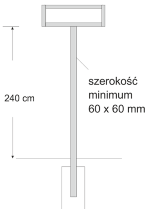
Rys. 95 Przykłady konstrukcji tablic
