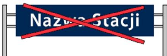
Rys. 92 Przykład niewłaściwej konstrukcji tablicy
